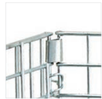
加强铰链对螺旋铰链起强化和保护作用，以防储物时绷开。
